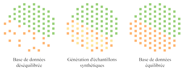
FIGURE 4 – Méthode SMOTE. En vert, la classe majoritaire. En orange, la classe minoritaire. En jaune, les échantillons synthétiques appartenant à la classe minoritaire.
